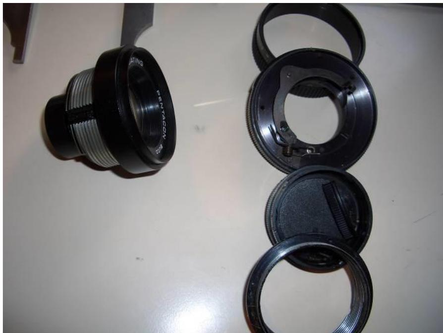
Une fois toutes les bagues déposées, le noyau de l'objectif est composé en général de 2 cylindres accolés, le premier diamètre de 26, 28 ou 30 mm sur 12 à 15 mm puis 45 à 55 mm de diamètre sur 30 à 35 mm, on peut parfois conserver la bague d'extrémité côté sortie pour manœuvrer facilement l'objectif.
